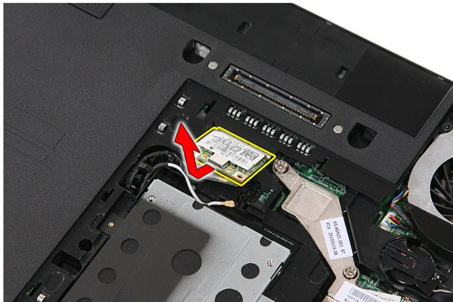
6. הסר את כרטיס ה-WLAN מהמחשב.
