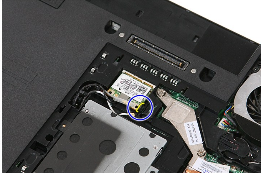
6. הסר את כרטיס ה-WLAN מהמחשב.
